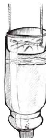
La partie la plus fine va pendre tête vers le bas et servir de robinet ou de distributeur de savon. On remplit la partie la plus large avec de l'eau en tenant la bouteille par la corde.
