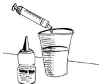
3. Expliquez le contrôle du chlore résiduel libre à l'aide de WataBlue en suivant les instructions du manuel «WataBlue». **Test WataBlue**
